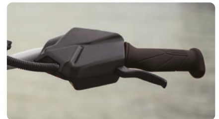
iBR® – intelligent broms- och backsystem iBR som är exklusivt för Sea-Doo®, bromsar vattenskotern snabbare och ger bättre kontroll och manövrering i låg hastighet och vid backning.
