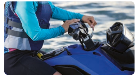
Styre med justerbar styrhøjare Ett teleskopiskt styrsystem som optimerar upplevelsen för förare med olika längd.
