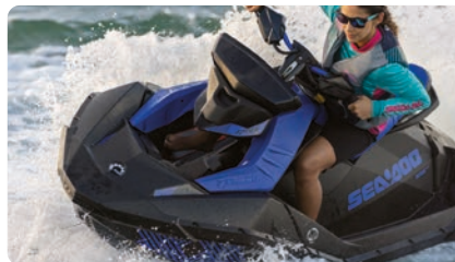
Spark®-skrov Spark-skrovet är utformat som en lätt och lekfull plattform. Det innovativa Polytec™-materialet minskar vikten ytterligare samtidigt som det optimerar prestanda och effektivitet. Den infärgade gjutningen är reptåligare än glasfiber.
